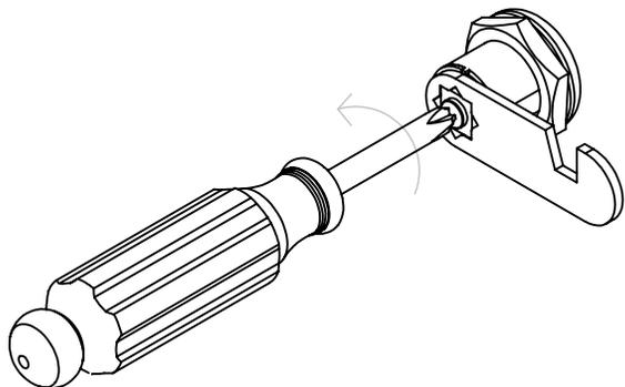
3. Manteniendo apoyada la chapa sobre la superficie plana, gire el candado como lo indica la Fig.2, de manera que la muesca quede invertida (Véase Fig.1 y Fig.2 para apreciar antes y después).
